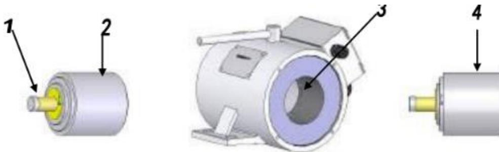
步骤 1：检查缓冲垫是否完整，若损坏须进行更换。
