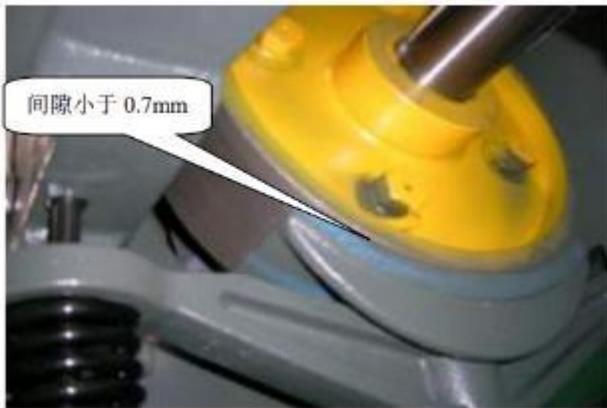
步骤六：调微动开关。调节微动开关 1 与 9，直到碰处制动器处，且“滴答”一声脆响，则锁紧螺母 2。（注意不能伸进去太长，以免制动器打开时，微动开关仍然接触制动器，不能超过预定的 2mm,因为一侧行程只有 2.5mm）此时，手动打开制动器手柄，观察微动开关，在此时应脱离制动器，否则重新调整。
